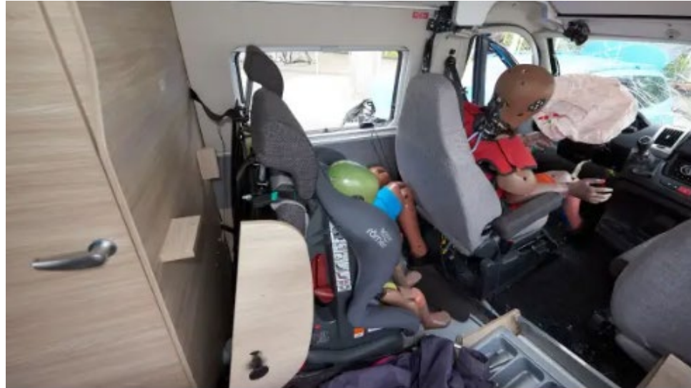
Die Holzkonstruktion der Sitzbank hielt dem Crash nicht stand • © ADAC/Uwe Rattay
