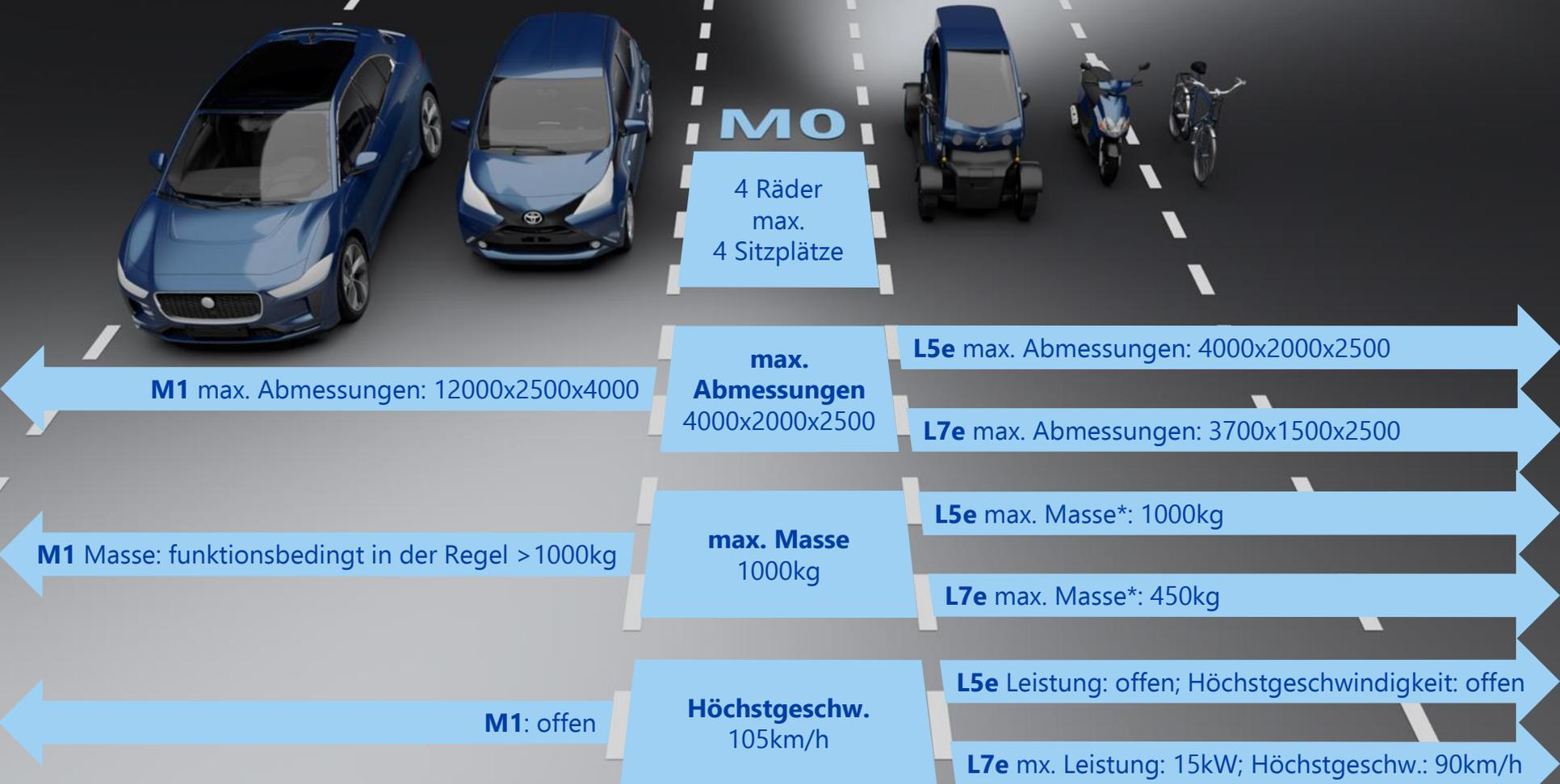
\* „Masse fahrbereit“ gilt bei elektrisch angetriebenen Fahrzeugen exklusive Traktionsbatterie.
