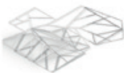
Primärtragwerk aus Hauptträgern
