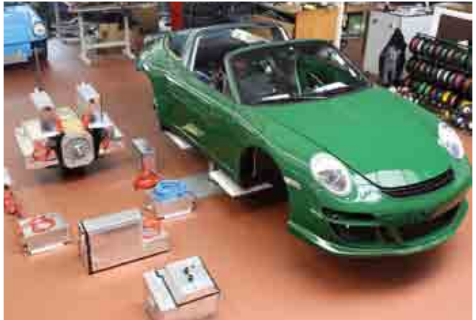
Grüner Flitzer: Techniker der Firma Ruf rüsten mit Hilfe von Siemens einen Porsche zum Elektroauto um. Wo Styroporblöcke als Platzhalter dienen, werden später Motor und Batterieblock eingebaut (Bild unten).
