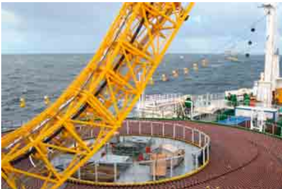
HGÜ-Kabel werden auf das Verlegeschiff geladen.
