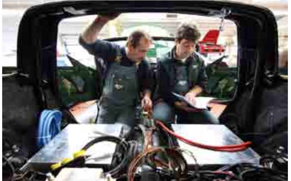
Herz des grünen Porsches: Zunächst wird der Elektromotor mit den Batterieblöcken verschraubt, bevor er in die Karosserie integriert wird und die Akkus auf den Rücksitzen angeschlossen werden.
