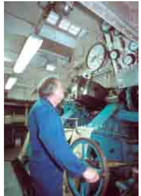
Bild 3: Im Steuerstand des Maschinenraums: Mit dem Rad wird nicht nur die Drehrichtung der Maschine und damit der Schaufelräder gewechselt, sondern auch die Expansionsveränderung verändert. Dies vergrößert oder verkleinert das Drehmoment und ist maßgebend für den Dampfverbrauch.
