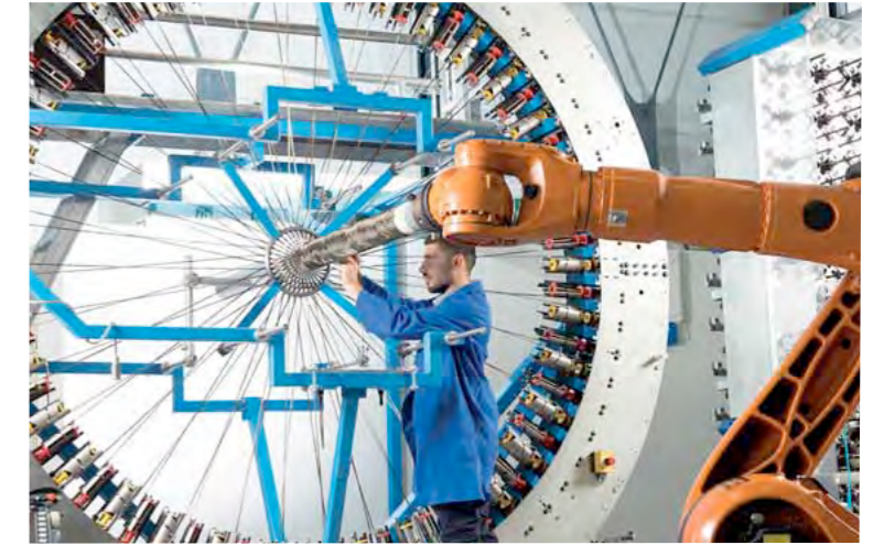
Flechten einer Faserverbundstruktur
