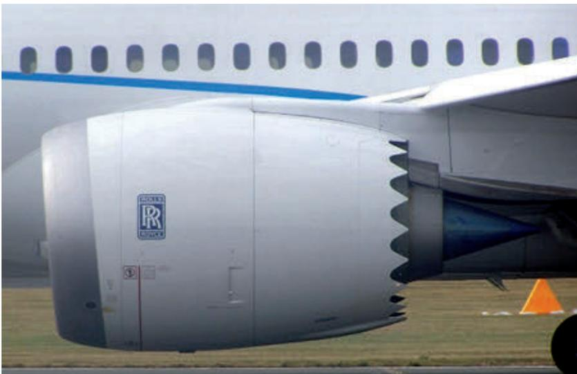
**Bild 3: Mantelstromtriebwerk mit Chevrons (sichelförmige Ausschnitte) am Fanghäuse, ein Kennzeichen für „leises Flugzeug.“
