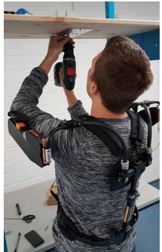
Testen von passiven Exoskeletten für die Überkopfarbeit im IAD-Labor
