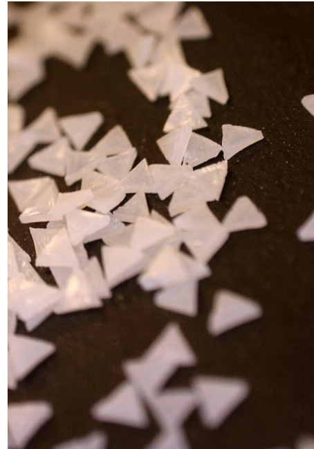
Makroaufnahme: Geometrisch geformtes Keramikkorn, Korn 36
