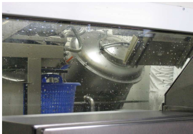
In dieser Trommel werden alle Zutaten zu Zaziki vermischt
