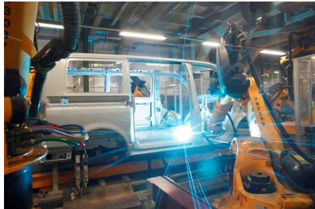
Bild 8: Schweißarbeiten im Rohbau
