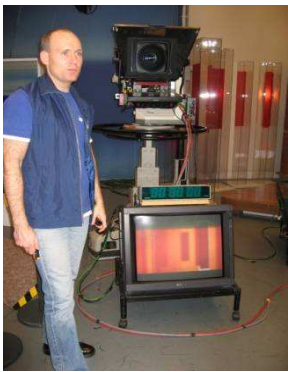
Fernsehkamera mit Kontrollmonitor und Teleprompter für den Moderator
