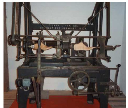
So wurde der Leisten früher mittels Kopierfräsen hergestellt (Museum Fagus).
