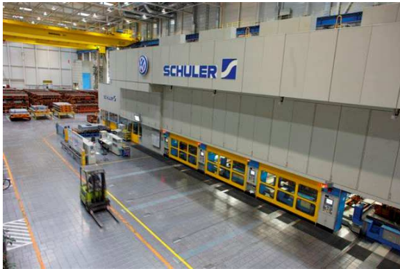
Bild 7: Grosspresse für z.B. das Dach oder Seitenteile
