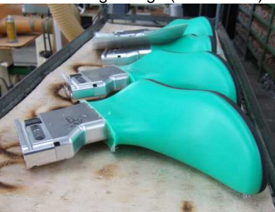
Leisten aus Kunststoff, auf CNC- Maschinen gefertigt (CAD/ CAM)
