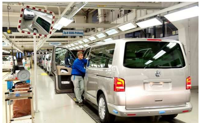
Bild 10: In der Fahrzeugmontage: Hier Innenausstattung
