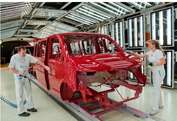
Bild 9: Kontrolle der lackierten Karosserie
