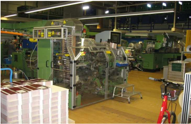
Automatische Verpackung der Zigaretten in Schachteln u. Stangen
