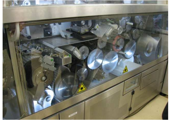
Moderne Maschine zur Zigarettenherstellung. 12.000 St./ min
