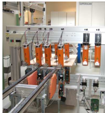
Ultraschallmessungen und Röntgen von verschiedensten Holzplatten und Materialien bietet Fagus als Service
