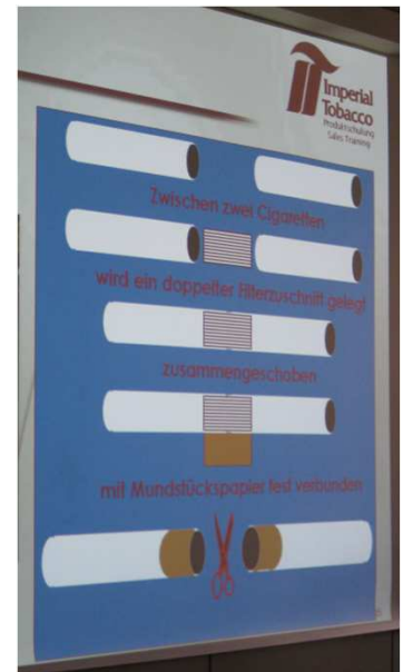
So werden aus einer langen Zigarette zwei mit Filter hergestellt.
