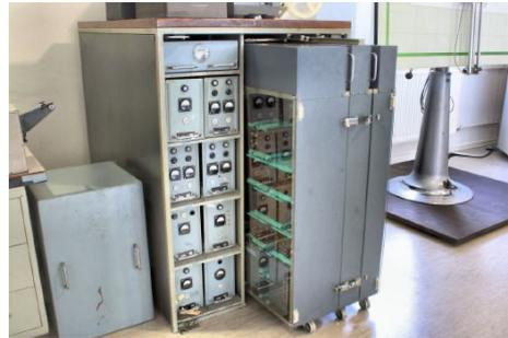
Ab 1963 mit Transistoren von Texas Instruments ausgerüstet. Es wurde 100 Maschinen gebaut. Leider wurde die Vorschrift für die max. Löttemperatur von 200°C nicht beachtet, sodass es nach der Inbetriebnahme zu großen Problemen kam, die mit entsprechendem Reparaturaufwand verbunden waren. Die Zuse KG war zu diesem Zeitpunkt bereits in finanzieller Notlage.
