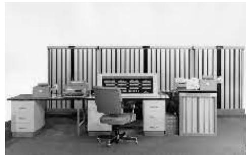
Ab 1961 mit der leistungsfähigeren Transistortechnik mit Glastransistoren gebaut. Die Schaltfunktion bestand aus einer gedruckten Steckschaltung.
