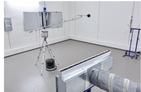
Messung des Schalldruckpegels nach dem Hallraumverfahren (Referenzschallquelle). Daraus wird die Schalleistung gerechnet. Ermittlung einer Richtcharakteristik nicht möglich
