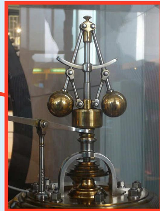
**... durch den Fliehkraftregler wurde daraus eine betriebstaugliche und robuste Maschine (1788)**
