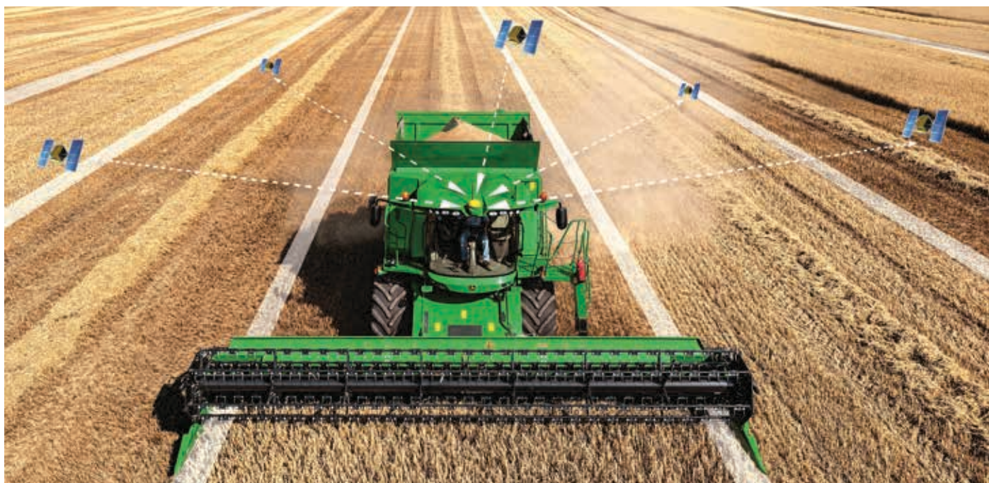
Spurführung eines Mähdreschers per Satellit
