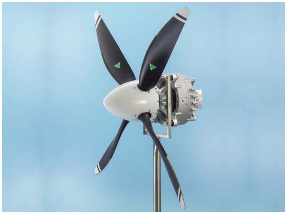
Neuartiger Elektromotor von Siemens, der bei einem Gewicht von nur 50 Kilogramm rund 260 Kilowatt elektrische Dauerleistung liefert – fünfmal so viel wie vergleichbare Antriebe.
