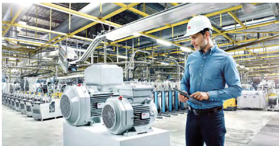
Der smarte Sensor ermittelt Werte wie Temperatur oder Vibration und überträgt sie via Smartphone oder Tablet an einen sicheren Cloud-basierten Server. Software von ABB analysiert die Daten und gibt den Kunden Empfehlungen für eine individuelle vorausschauende Wartung.
