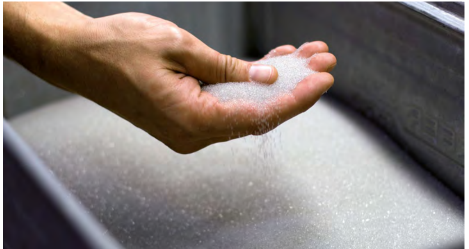
Kleine Glaskugeln gelangen aus einem Vorratsbehälter in die Füllmaschine. Zu geringen Füllstand meldet die SmartBridge über einen Koppler an eine Cloud-Software.
