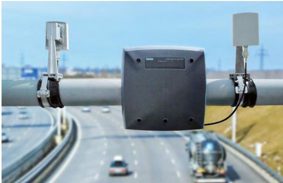
*Der Autoflüsterer: Im Rahmen des Projekts Car2X sollen Roadside Units entlang der Teststrecke mit den Testfahrzeugen kommunizieren.*
