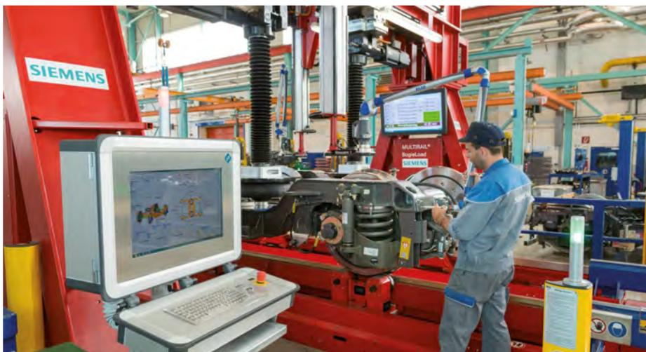
Digitale Hilfsmittel: Auf dem Prüfstand werden die Drehgestelle auf fest vorgegebene Werte penibel übergeprüft.
