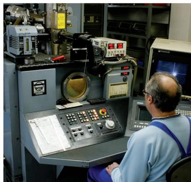
Elektronenstrahlschweißanlage mit 15 kW Leistung und 600 l Kammervolumen
