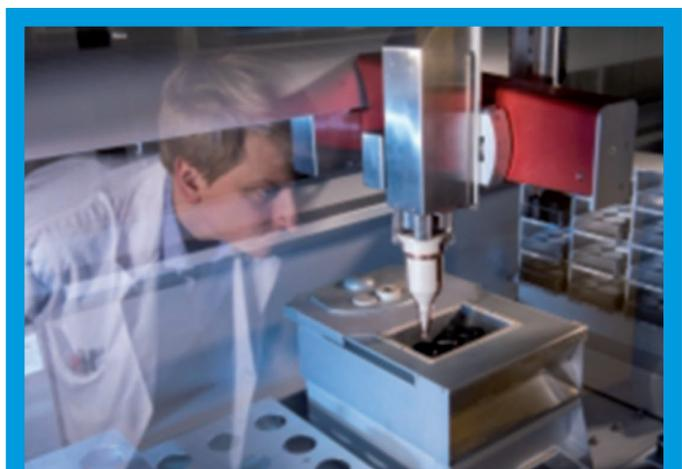
Mit dem Pulverdosiroboter lassen sich Rezepturen für neue Werkstoffe mischen.
