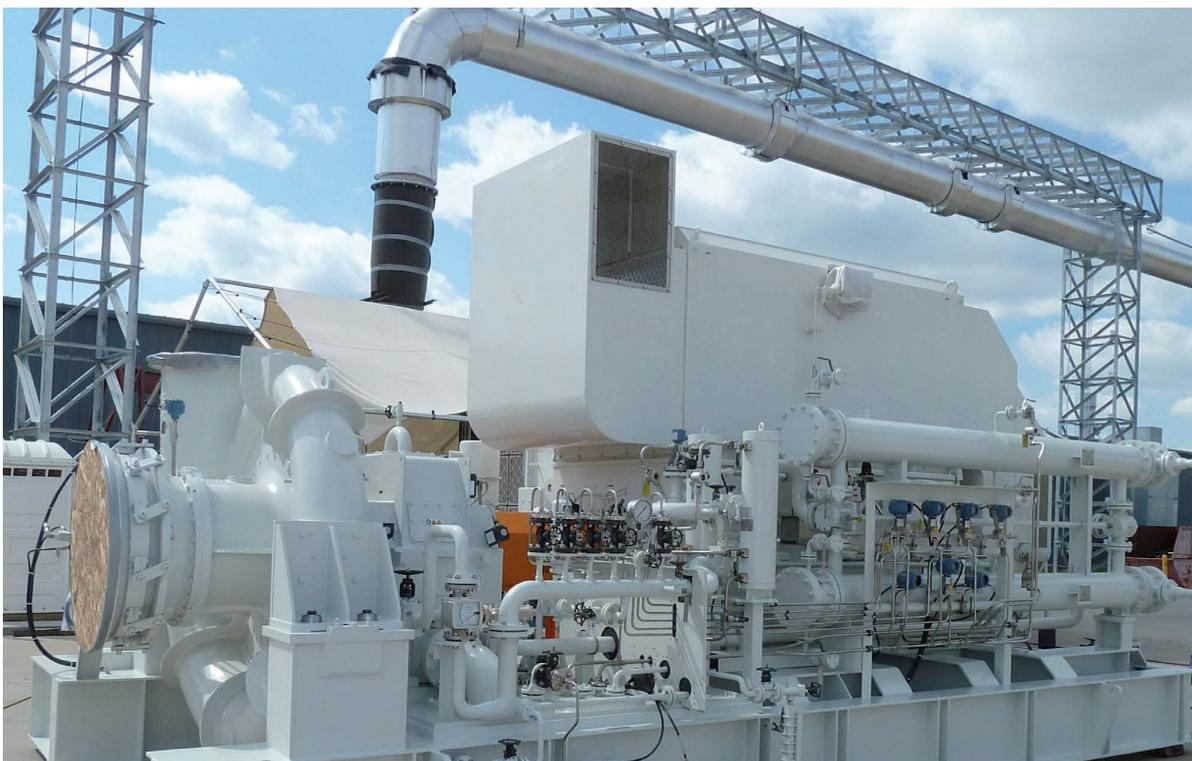
Beispiel für einen Verdichter aus Frankenthal, der in einer Schwefelrückgewinnungs-Anlage in Qatar eingesetzt wird.
