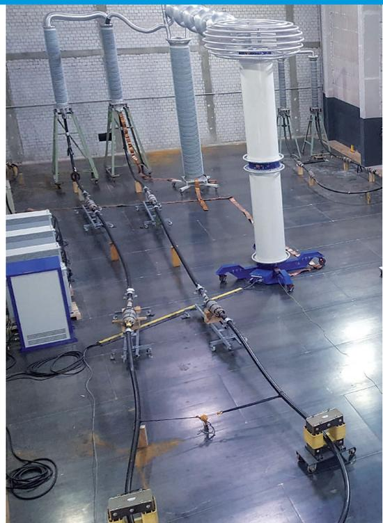
Prüfaufbau von Gleichspannungs-Langzeituntersuchungen
