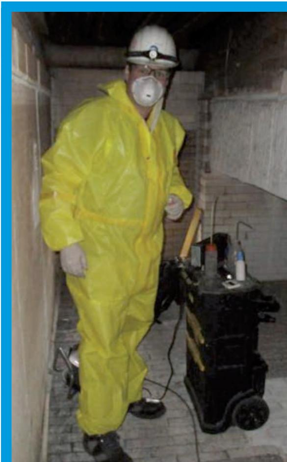
Ambulante metallografische Untersuchung an Produktrohren innerhalb eines Ofens mit elektrolytischer Ätzung
