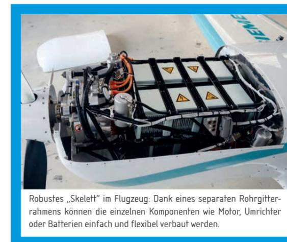
Robustes „Skelett“ im Flugzeug: Dank eines separaten Rohrgitterrahmens können die einzelnen Komponenten wie Motor, Umrichter oder Batterien einfach und flexibel verbaut werden.
