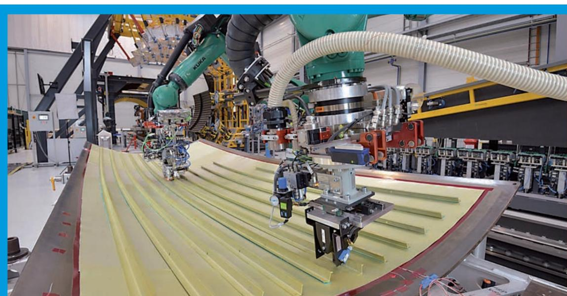
Abbildung 1: Realer Prozess der automatisierten Stringerintegration mit kooperierenden Robotern in eine Flugzeugrumpfschale in der Forschungshalle des Fraunhofer IFAM im Forschungszentrum CKF NORD, Stade (© Fraunhofer IFAM).
