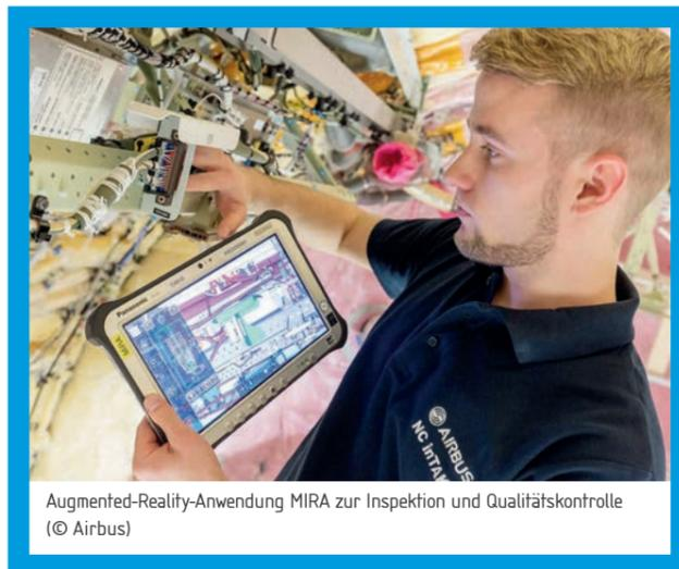
Augmented-Reality-Anwendung MIRA zur Inspektion und Qualitätskontrolle (© Airbus)
