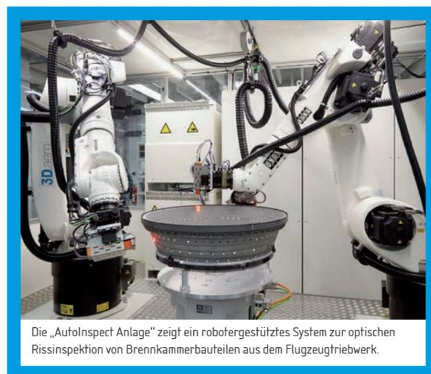
Die „AutoInspect Anlage“ zeigt ein robotergestütztes System zur optischen Rissinspektion von Brennkammerbauteilen aus dem Flugzeugtriebwerk.
