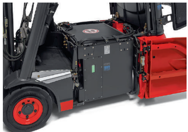
Batterie eines Staplers von Linde MH
