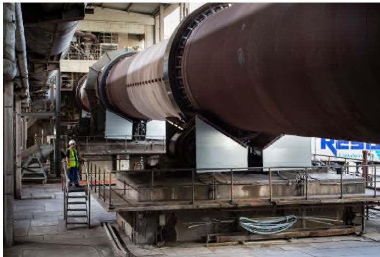
Eine interessante Konstruktion des Maschinenbaues: Der Drehrohrofen mit einem Durchmesser von 4 und einer Länge von 68 Metern dreht sich mit 2,5 Umdrehungen pro Minute und hält eine Verbrennungstemperatur von mehr als 2000 Grad Celsius stand.
