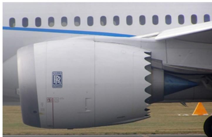
**Bild 4: Mantelstromtriebwerk am Flugzeug:** Trent 1000 - Triebwerk mit Chevrons (sichelförmige Ausschnitte) am Fanggehäuse, ein Kennzeichen für „leises Flugzeug.“
