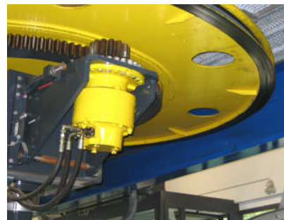
Schwenkbarer Hydromotor mit Ritzel
