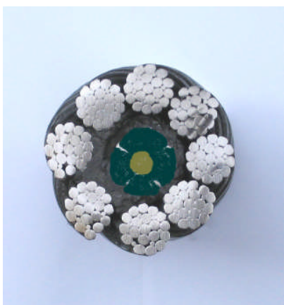
Querschnitt durch das Seil, in der Mitte die „Seele“ aus Kunststoff
