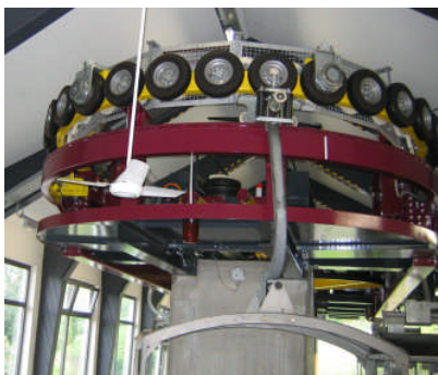
Umlauf der Kabinen in der Talstation, die durch die sich drehenden Autoreifen bewegt werden
