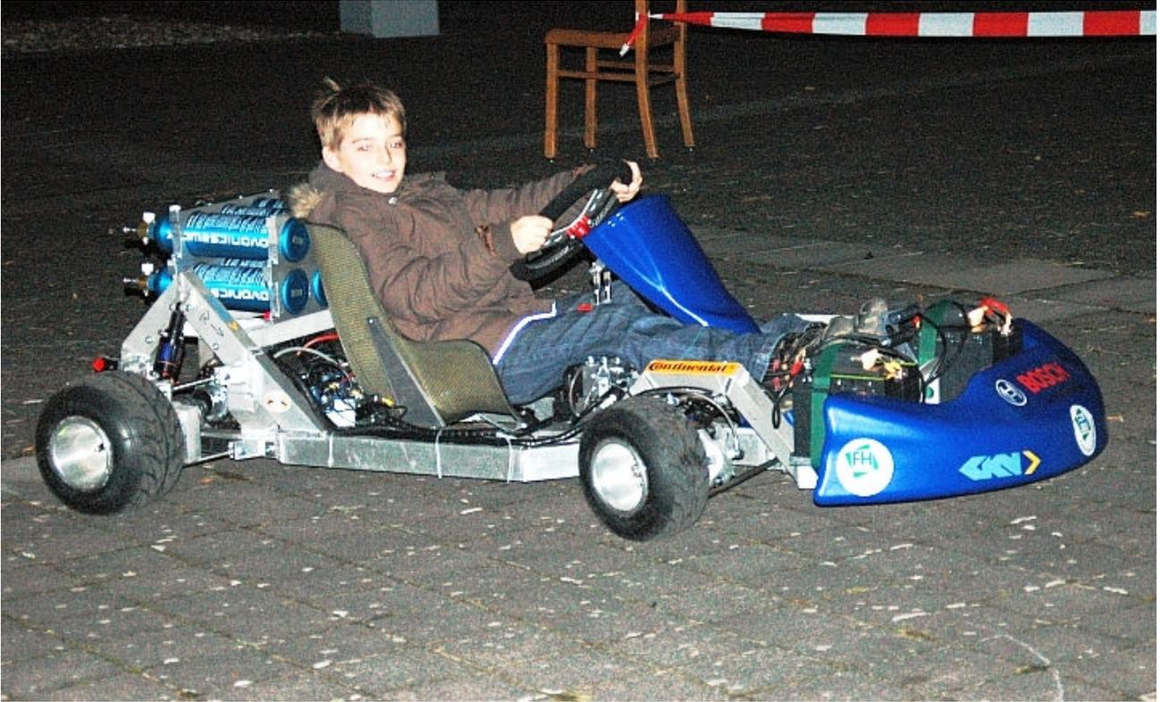
**Ein Attraktion für alle Besucher:** Das Forschungsfahrzeug des Labors für Automobilentwicklung (LAB), ein durch Batterie und Brennstoffzellen angetriebenes Kart. Technische Daten: Direktantrieb ohne Getriebe durch zwei Elektromotore mit Differential-Funktion. Leistung: 2x3,5 kW. Max. Drehmoment: 2x35 Nm, Fahrdauer ca. 30 min bei Vollast. Doppelquerlenker-Radaufhängungen, Luft-Federung-Verstelldämpfer. Gesamtlänge/-breite: 1400/1100 mm, Gewicht: 250 kg. Bild: A. Krause
