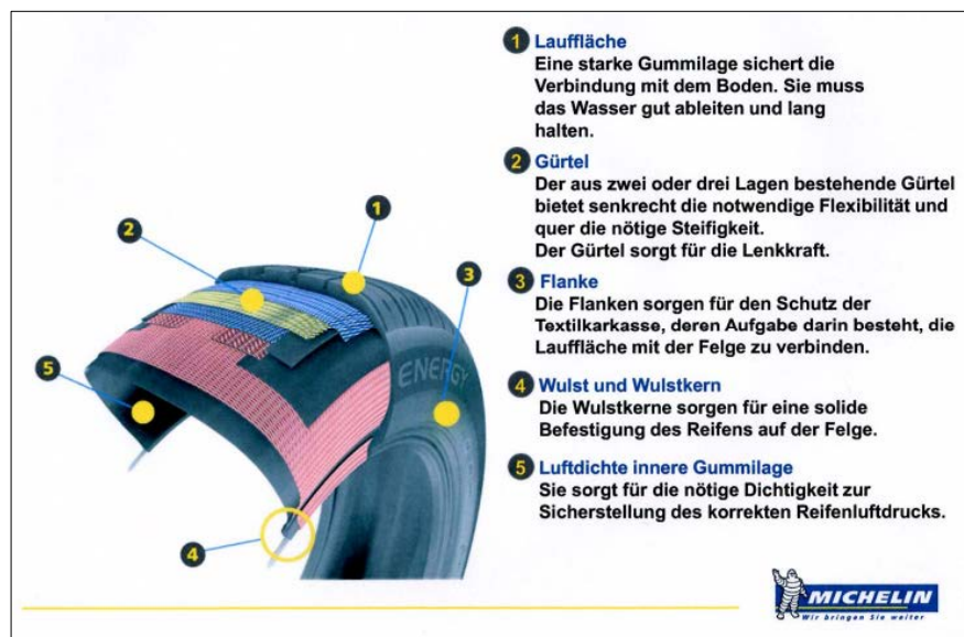
Bild 3- Grundsätzlicher Aufbau: Der Radialreifen besteht aus mehreren Komponenten, die jede für sich eine wichtige Funktion übernehmen und die in ihrer Gesamtheit die Eigenschaften des fertigen Reifens bestimmen
