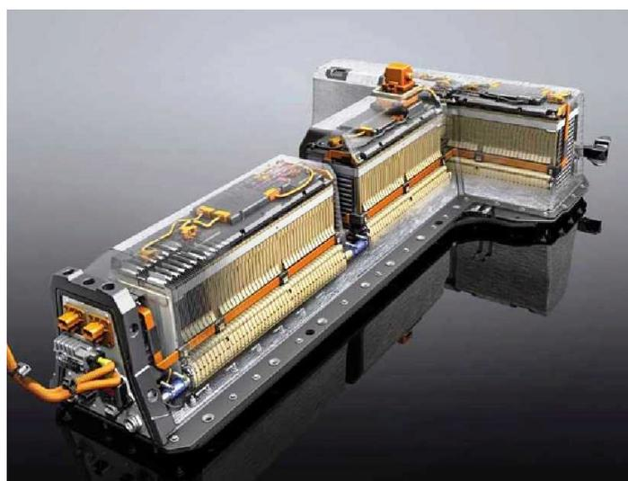
**Erfüllt die Forderungen eines Elektroautos zur Zeit am besten:** Die Lithium-Ionen-Batterie. Hier: 288 Zellen, 360 V Spannung, 16 kWh Kapazität, 180 kg Gewicht, 1,7 m Länge
