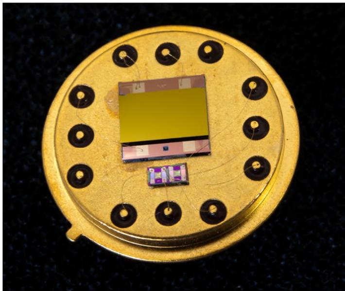
**Der Herzstück der „Marstauglichen Apparatur“:** Der in Rüsselsheim entwickelte Sensor
