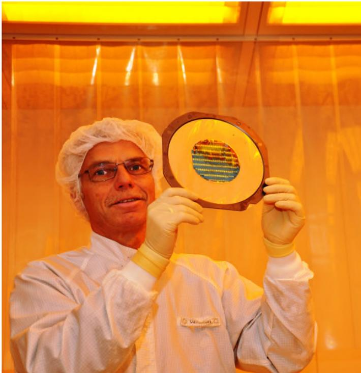
**Zufrieden und stolz:** Prof. Dr. Friedemann Völklein begutachtet im Reinraum die präzise getrennten Sensoren eines Siliziumwafers, die 2016 in einem Massenspektrometer mit zum Mars fliegen werden.
