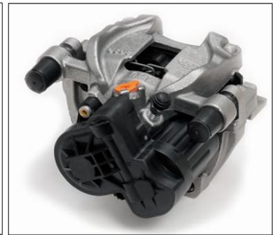
**Bild 4 und 5-** Die zwei wichtigsten Produkte des Werks Rheinböllen: Ein hydraulische Bremsattel (linkes) und ein hydraulischer Bremsattel mit integrierter elektrischer Parkbremse (rechts).
