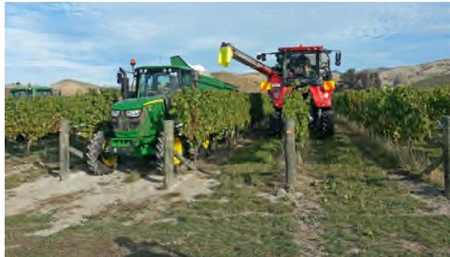
**Geeignet für große Rebflächen:** Der ERO-Traubenvollernter mit Überladeband im Einsatz in Neuseeland. Mithilfe des Überladebandes werden die geernteten Trauben kontinuierlich auf ein fahrendes Transportfahrzeug geladen.
