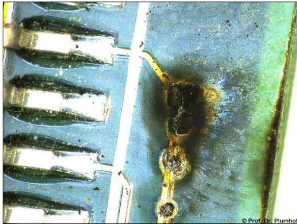
**Bild 6** In einem Lötunkt beschädigte Platine
