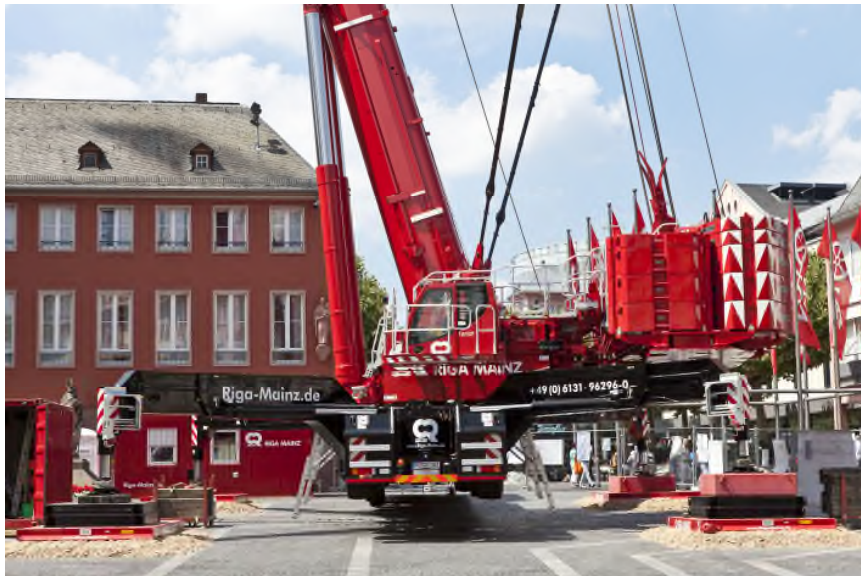
Bild 2 Hohe Standsicherheit ist Voraussetzung für alle Kranarbeiten: Die hydraulisch ausfahrbaren vier Abstützträger mit angebauten Stützzylindern vergrößern die Standfläche erheblich und erhöhen die Tragfähigkeit bei ausreichender Standsicherheit. Die Stahlplatten unter den Stützzylindern verringern den Bodendruck.
