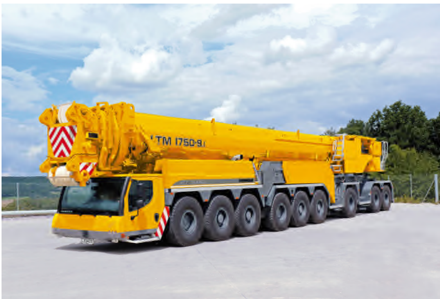
Bild 3 Bestand die Bewährungsprobe in Mainz: Der LTM 1750-9.1 von Liebherr. Dieser Fahrzeugkran, hier fertig für eine Straßenfahrt, erreicht eine maximale Geschwindigkeit von 80 Kilometern pro Stunde. Abmessungen: Länge 21,75, Breite 3,1 Höhe 4 Meter, Gewicht 108 Tonnen. Maximale Traglast: 750 Tonnen bei 3 Metern Ausladung. Teleskopausleger 16,3 bis 52 Meter. Gitterspitzenverlängerungen und wippbare Gitter-Ausleger von 6 bis 91 Metern sind anbaubar und erweitern die Ausladung beträchtlich.
