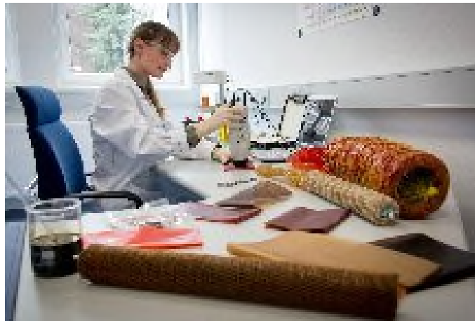
Bild 2 Qualitätssicherung: Im Labor werden Merkmale geprüft, die sich einer Kontrolle während der laufenden Produktion entziehen, zum Beispiel die Farbtreue.
