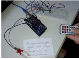
Feuchtigkeitssensor, damit sich die Blumen wohl fühlen mit der Fernbedienung grün (o.r.). Das Bewässerungssystem gießt bedarfsgerecht und nutzt zur Stromversorgung eine Solarzelle.
