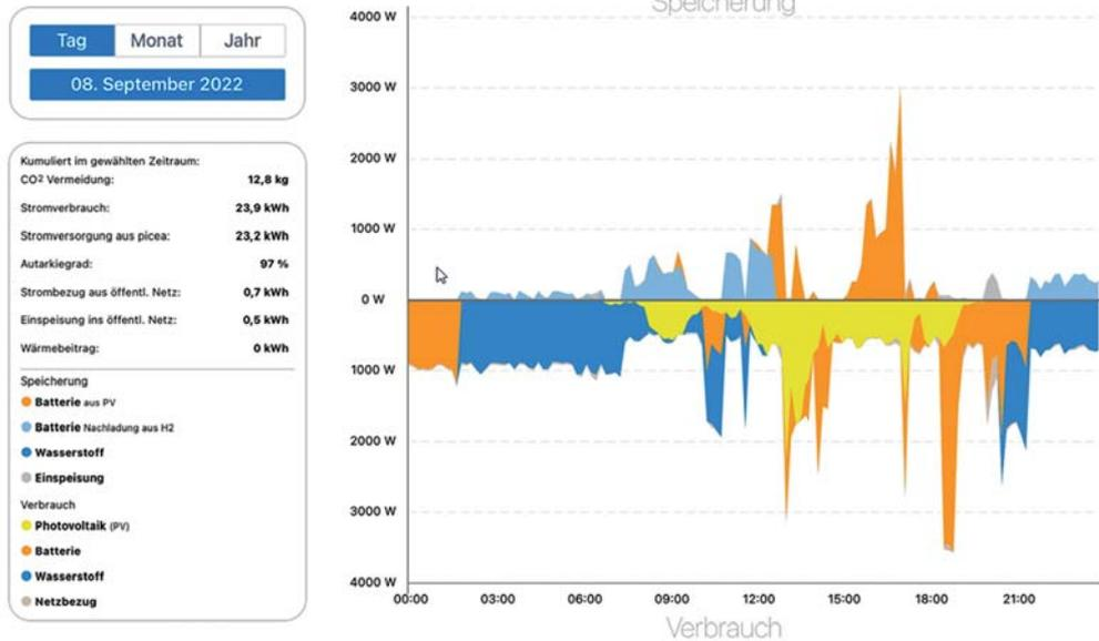
Aus dieser Übersichtsgrafik geht hervor, dass der Wasserstoff in erster Linie in der Nacht erzeugt wird (mit maximal 1 kWh pro Stunde). Das kann ja nur aus der Batterie erfolgen. Dazu muss man aber sicher sein, dass am Morgen/Vormittag genügend »Saft« aus der Photovoltaik-Anlage verfügbar ist. Das wird auf Basis der Sonnenstundenvorhersage gesteuert. Die Anlage erhält Online eine Wetterprognose und berechnet den zu erwartenden Photovoltaik-Ertrag für den anstehenden Tag.
