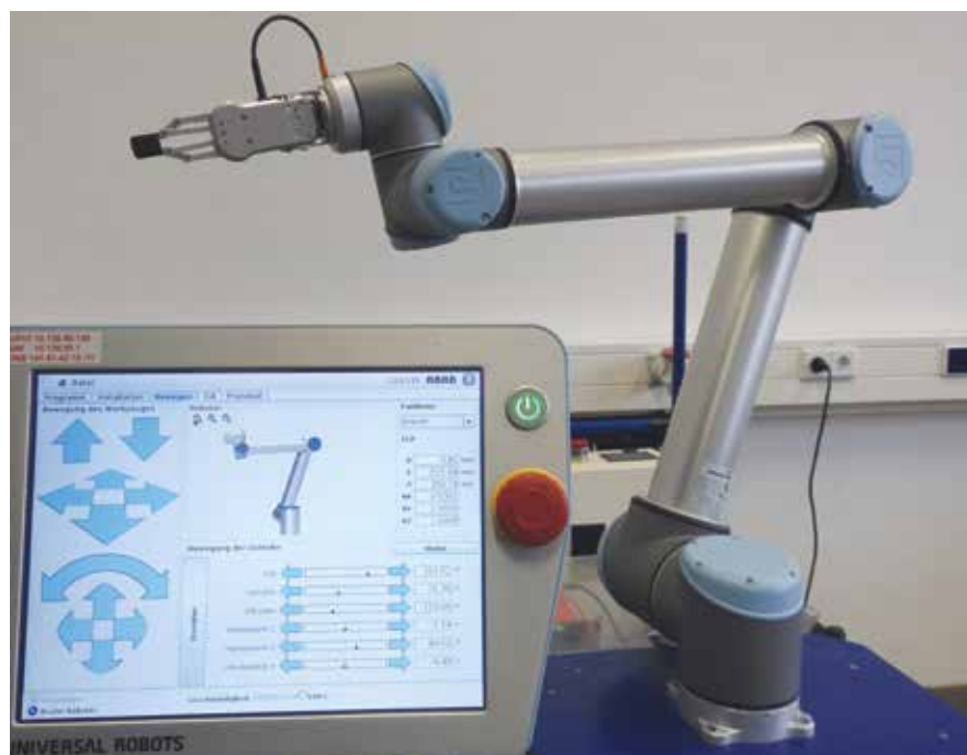
Fast wie beim iPad: Roboter des Herstellers Universal Robot erhalten ihre Befehle über eine Eingabeoberfläche.
