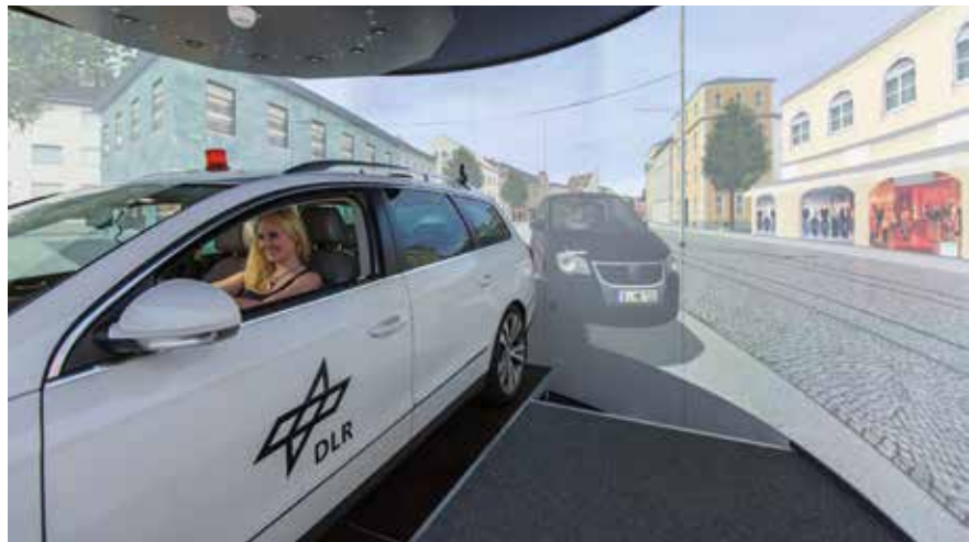
Auf Nummer sicher: Erprobung von Interaktionskonzepten für Level-3-Fahrzeuge in Simulatoren des DLR in Braunschweig.
