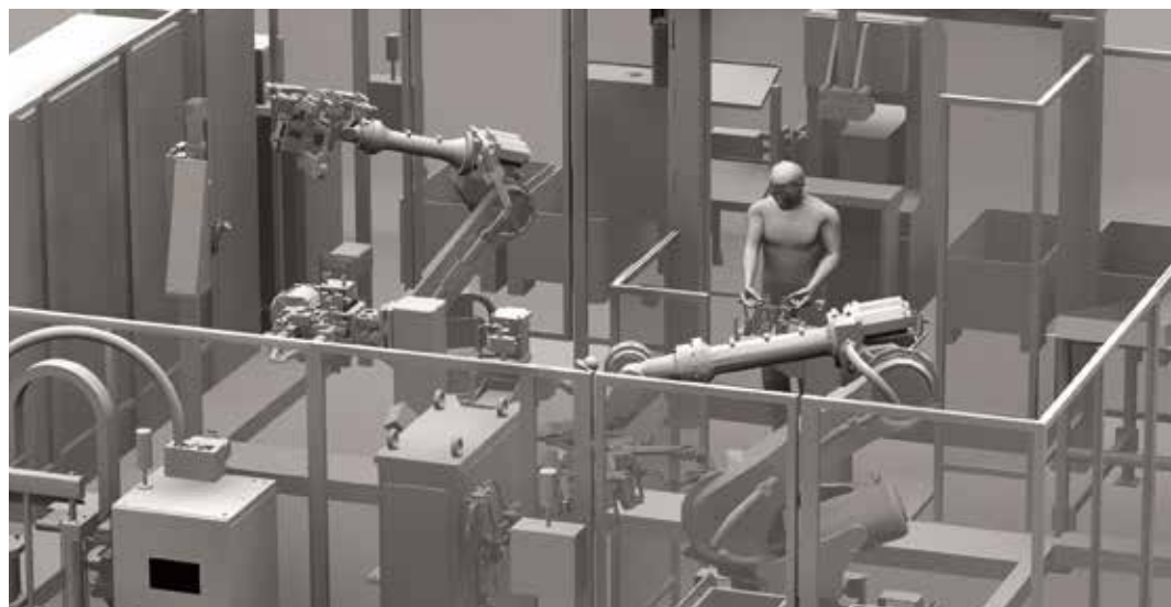
Diese 3D-Visualisierung simuliert das Zusammenspiel von Werker, Roboter und Vorrichtung.
