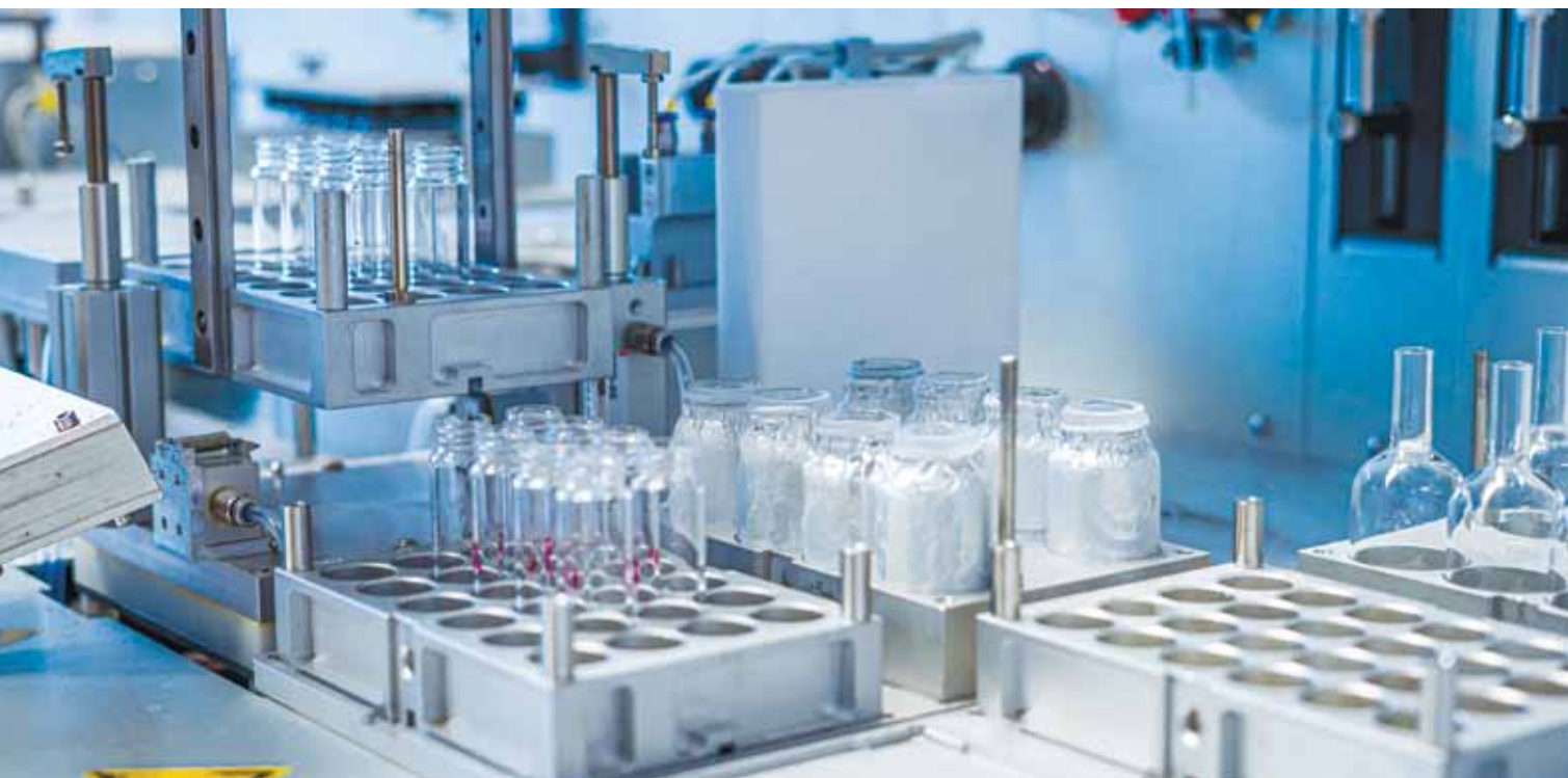
Automatisiertes Liquid-Handling-System am PVZ zur Aufarbeitung flüssiger Proben im Hochdurchsatz.
