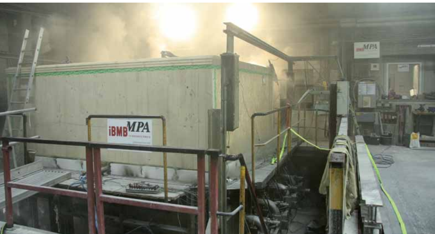
In Großbrandversuchen untersucht die TU Braunschweig, ob mehrgeschossige Holzgebäude auch bei Feuer genauso sicher sind wie Gebäude aus Stahlbeton.
