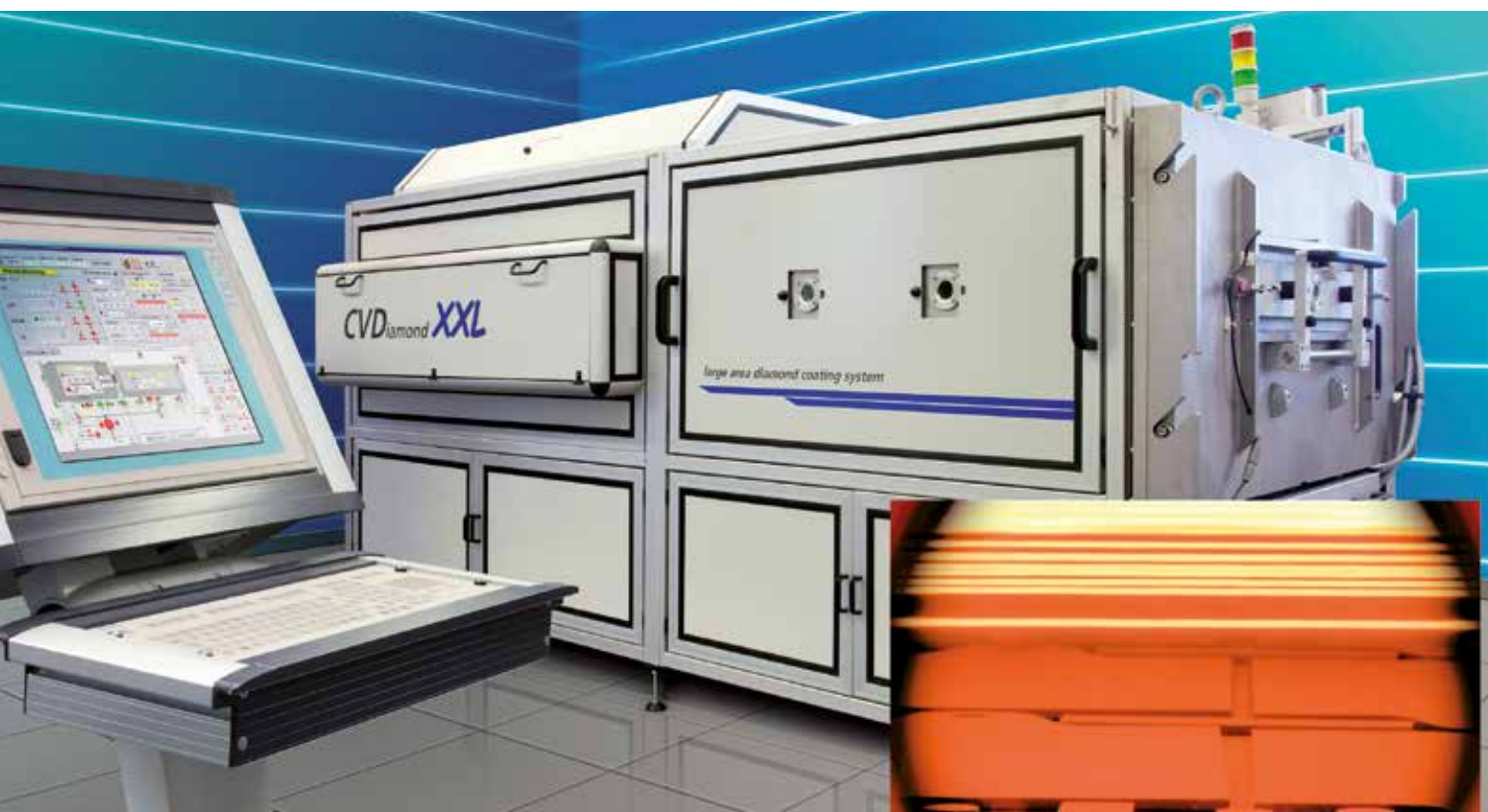
Das Fraunhofer IST nutzt eine selbst entwickelte Heißdraht-CVD-Anlage, um auf einer Größe von 1 Meter mal 0,5 Meter Diamantschichten auf Elektroden abzuschneiden.
