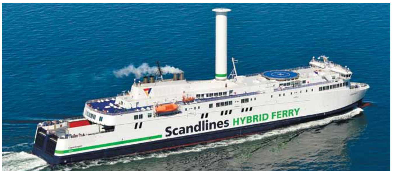
Das 30 Meter hohe Rotorsegel der Copenhagen spart so viel Treibstoff, dass der CO 2 -Ausstoß der Fähre um vier bis fünf Prozent sinkt.
