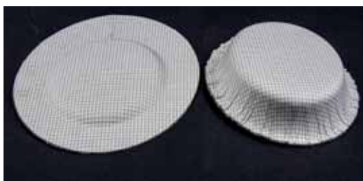
Abb. 3: Umformen durch Dehnung des Fasernetzwerks (links) und durch Faltenbildung (rechts)
