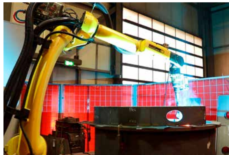
Die SIMMI-Partner entwickeln einen Industrieroboter, der das Mehrlagenschweißen sicherer macht. © (2): Fraunhofer IFF
