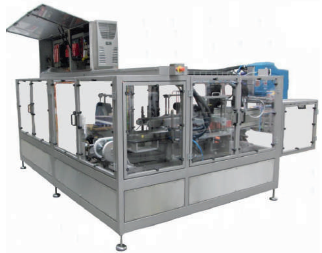
Winkelverschliesser für Top Load Anlagen mit Servoantrieben
