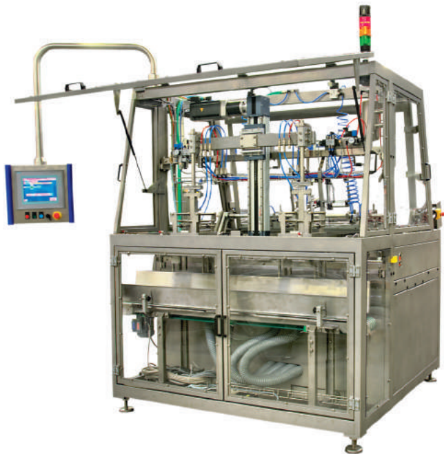
Faltschachtelaufrichter für Top Load Anlagen mit Servoantrieben
