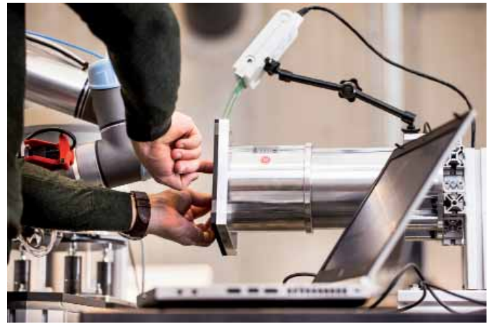
Exemplarischer Messaufbau für Kraft- und Druckmessung zur Validierung der Sicherheit bei möglichem Kontakt mit einem kollaborativen Roboter © Danish Technological Institute
