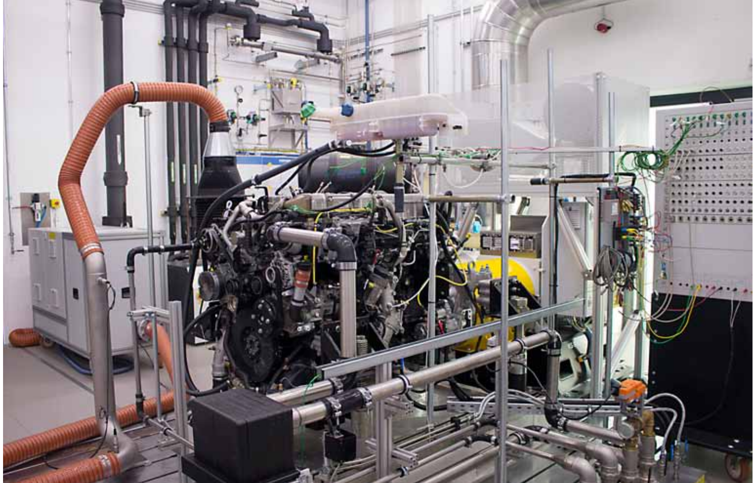
Die Tornado Software simuliert dem Dieselmotor einen echten Lkw und die Belastungen einer realen Fahrt. So kann auf diesem Power Pack-Prüfstand das Zusammenwirken der einzelnen Komponenten getestet werden. Fotos (4): Kathrain Graubaum
