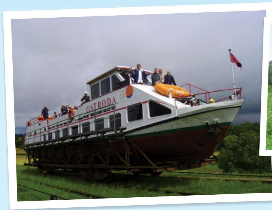
☛ BILD LINKS: DAS SCHIFF „OSTRÓDA“ MIT DEM TRANSPORTWAGEN AUF DER GENEIGTEN EBENE, OBERLÄNDISCHER KANAL, POLEN, URHEBER: HENRYK BORAWSKI; BILD RECHTS: GENEIGTE EBENE VON UNTEN GESEHEN, URHEBER: WSOMBECK
