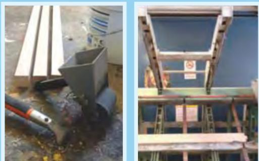
Erst mit Leim einschmieren und für eine Stunde in die Druckluftpresse. Danach drei Stunden warten.
