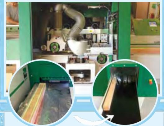
Die Laser zeigen, bis wohin die Maschine hobeln wird.
