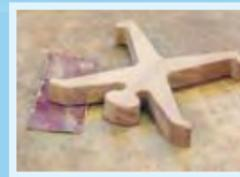
Mit der Schleifmaschine und mit Schleifpapier wird die Figur ein letztes Mal glatt und rundgeschliffen.
