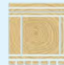
Was ein Balken, eine Bohle, ein Brett oder eine Latte ist, hängt von der Länge der Kanten ab. Ein Balken ist 20 cm oder mehr hoch und breit. Eine Bohle ist mindestens 4 cm hoch und muss mindestens doppelt so breit sein. Ein Brett ist mindestens 8 cm breit und zwischen 8 und 40 mm dick. Als Latte bezeichnet man alles, was weniger als 8 cm breit ist.
