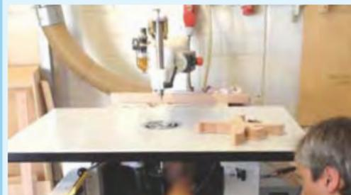
Diese Fräse steht fest. Man muss das Werkstück mit der Hand daran entlangführen und die Kanten ...
