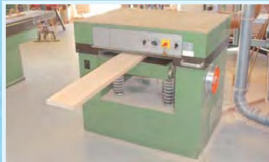
Das so entstandene Brett muss in der Dicke (in der genauen Höhe) vom Leim befreit werden, der aus den Fugen gequetscht wurde.
