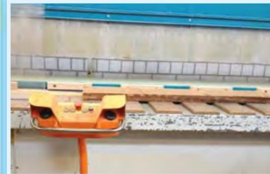
Die Langkreissäge funktioniert nur, wenn man beide schwarzen Knöpfe gleichzeitig drückt. So können die Hände nicht in die Nähe der Säge geraten.
