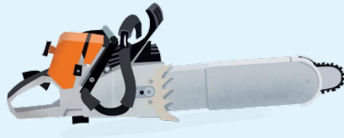
**Rettungssäge** Sägt Holz, Dachpappe, Metall und sogar Beton. Das Sägeblatt ist mit Diamanten besetzt und von einer Hülle umgeben, die man vor- und zurückschieben kann. So lässt sich die Schnitttiefe verstellen. Damit die FW-Leute nicht aus Versehen mal ausrutschen und mit der Säge einen Patienten verletzen.
