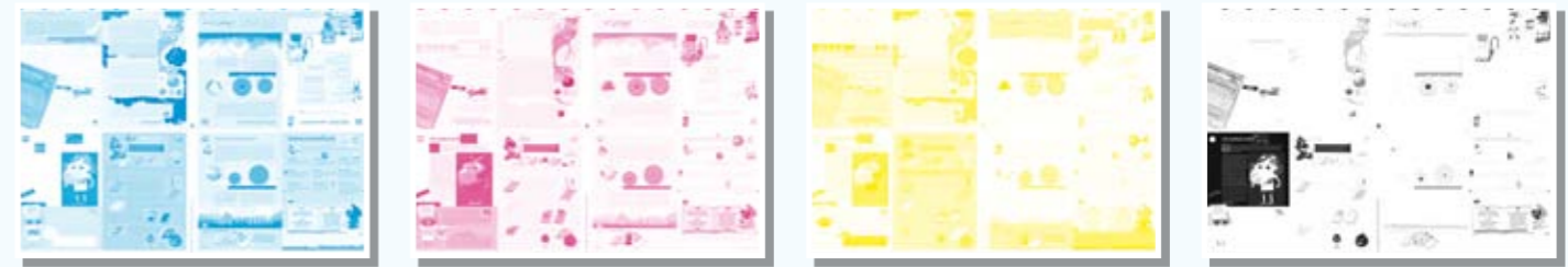
Die vier Druckplatten zeigen das fertige Bild in seine vier Druckfarben (CMYK) zerlegt.
