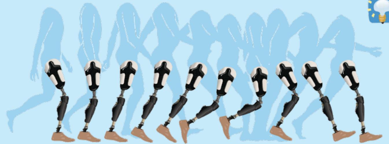
Die Prothese läuft natürlich nicht von allein. Der Mensch bringt sie durch seinen Oberschenkelstumpf zum Gehen oder besser zum Pendeln. **Sensoren** erkennen, wie schnell das geschieht und in welcher Phase des Gehens sich der Mensch gerade befindet. Je nachdem sorgt die **Hydraulik** dafür, dass der Unterschenkel rechtzeitig und genau mit der richtigen Kraft abgebremst wird, damit er wieder in die andere Richtung schwingen kann.
