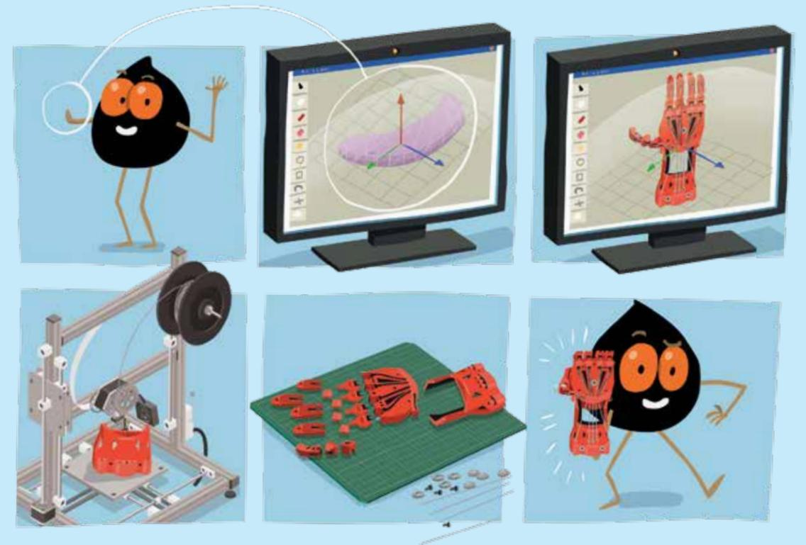
Das Kind muss nur seinen Unterarmstumpf und den anderen Arm **scannen** lassen und dann die Bilder an einen Designer mailen. Der baut im Computer das **Modell** einer Handprothese – nur für dieses Kind. Das fertige Design wird von einem **3-D-Drucker** gefertigt, Stück für Stück, und schließlich **zusammengebaut**. Kinder können mit der nur 250 Gramm leichten 3-D-Hand einfache Dinge erledigen: eine Wasserflasche
