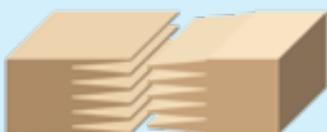
Die langen Balken sind aus mehreren kurzen Balken zusammengeklebt! Wenn ein Riese so einen Balken zerbräche, würde der nie an der geleimten Stelle kaputt gehen! Das liegt an der **Keilzinkung**. Überlege selbst, warum das so ist, und schicke uns deine Vermutung an [rudi@vdiniclub.de](mailto:rudi@vdiniclub.de). Nicht fudeln!
